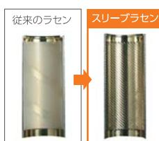
カツシカの開発した容器に、スリープラセンシステムがあります。これは口紅保護用のスリープ内部全面に多条のラセンをプレス加工し、紅皿のダボを多条にかみ合わせることで、従来商品に比べて、快適な上下動、省部品化、製造工程の省略化、スリムな外観などを実現しました。
